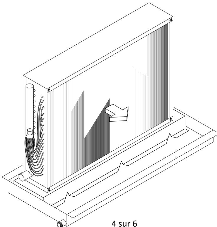
Le périmètre autour du boîtier du serpentin doit être scellé pour empêcher l'air de passer par le serpentin.
